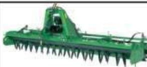
**FUNZIONE.** E' una macchina agricola che, oltre a svolgere l'erpicazione (la rifinitura del terreno), si presta, a differenza degli altri tipi di erpice, a molteplici funzioni quali, l'interramento dei residui del raccolto, la rimozione delle erbe infestanti, la miscelazione nel terreno di letame e concime ed altro. Può essere di tipo portato o trainato.
