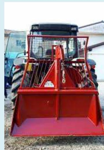
Il concentramento a strascico con verricello, detto anche strascico indiretto perchè la macchina sta ferma, consiste nel trascinare il legname mediante una fune di acciaio di un verricello sul terreno del bosco, lungo le linee di massima pendenza. Si effettua su distanze massime di circa 100 m in salita, 50 m in piano e 30 m in leggera discesa.
