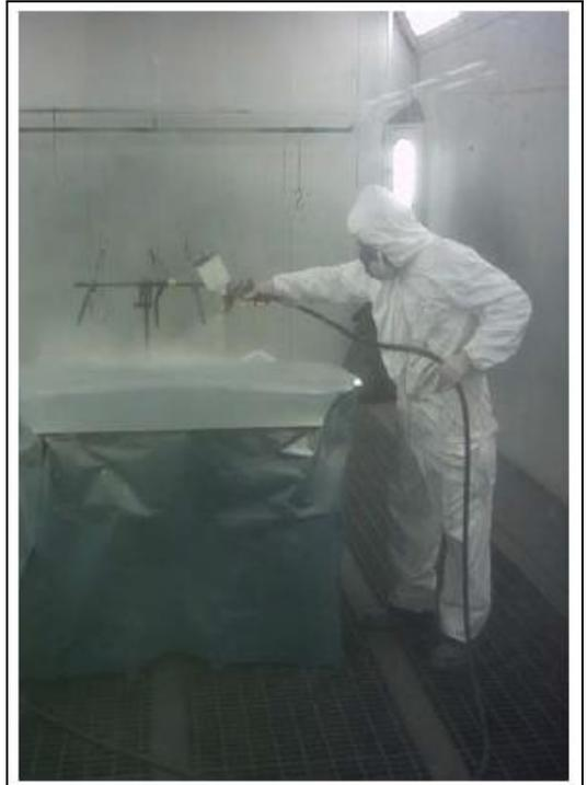
Il flusso laminare, prodotto dall'impianto di aspirazione, potrà essere verticale oppure orizzontale; il valore della velocità dell'aria, che deve essere garantito all'interno della cabina, dovrà rispondere a quanto previsto dalla **norma UNI EN 12215: 2005**, a seconda del tipo di cabina.
